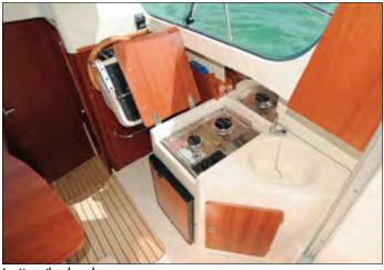
Le siège pilote bascule vers l'avant, dévoilant deux feux à gaz proposés en standard.
